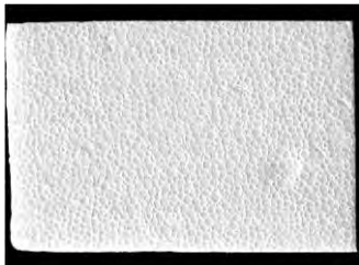
EPS (Weiß): Wärmeleitfähigkeit 0,035 - 0,040 W/mK Rohdichte 10 - 50 kg/m 3
