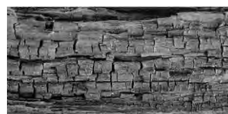
Abb. 31: Holzschutz, Braunfäule (links), Echter Hausschwamm (rechts)
