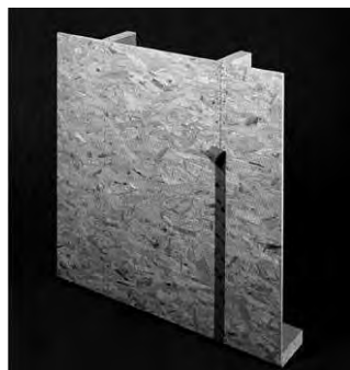
Abb. 32: Diffusionsoffene OSB-Beplankung raumseitig mit geklebten Plattenstößen
