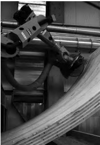
Abb. 8: CNC gesteuerter Fertigungsroboter, Herstellung von Massivholzplatten (finnforest MERK)
