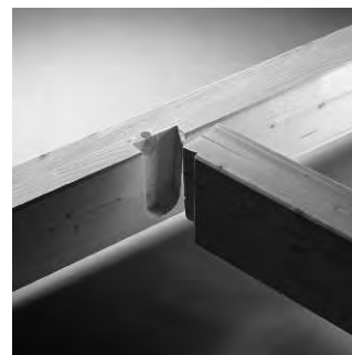
Abb. 9: maschinelle Herstellung von traditionellen Verbindungsmitteln: z.B. Schwalbenschwanz
